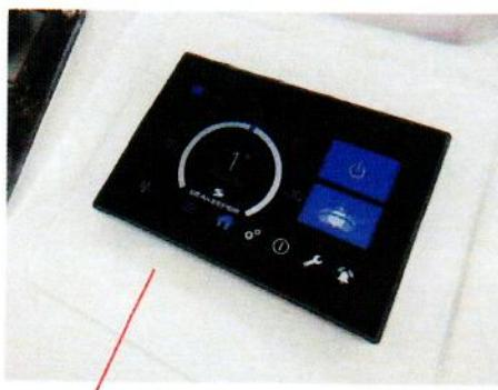
**PANEL:** Et enkelt kontrollpanel hvor du kan følge med på krengingsgrader og raskt slå gyro-systemet av og på.
